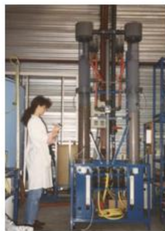
Filtre à sable
